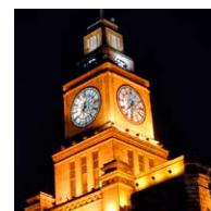
Jedes der vier Zifferblätter am Uhrenturm hat einen Durchmesser von 5,3 Metern und besteht aus 100 Glaseilen.
