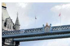
*Les passerelles du niveau supérieur ont été conçues de façon à ce que le public puisse traverser le pont même lorsqu'il est relevé.*
