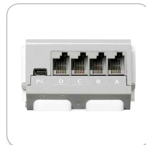
Connexion des moteurs
