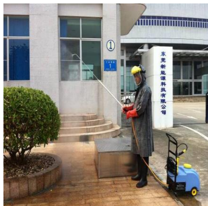
图片 2 水雾灭火器 (穿着 PPE 防止触电)
